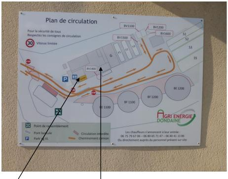
Sur le plan ci-contre, nous pouvons remarquer les 4 cuves en bas (les 2 digesteurs au centre et une cuve de stockage à chaque extrémité). A droite, les 4 rectangles sont les silos de stockage (cf. photo supra). Le cœur de l'usine est « la salle des machines », avec des tuyauteries de différents diamètres, des vannes, des pompes de différentes puissances, etc. Nous avons visité la « salle de pilotage électronique ». C'est une véritable usine.
